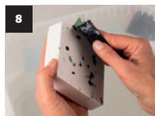
**8** Immédiatement après le démoulage, poncer le Raysin encore humide avec du papier émeri humide de grain 120 (grossier) jusqu'à ce que les flocons soient clairement visibles sur la surface. Rincer toujours à nouveau le sujet sous l'eau courante ou dans un bol.
